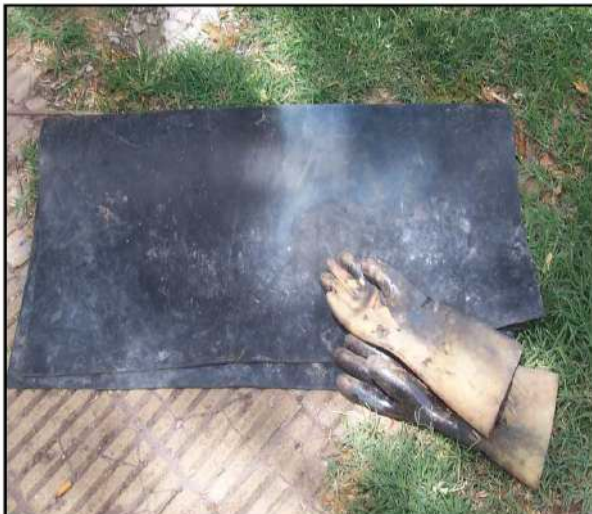
Fotografía 1: Manta y guantes dieléctricos afectados por el calor de la descarga eléctrica.
